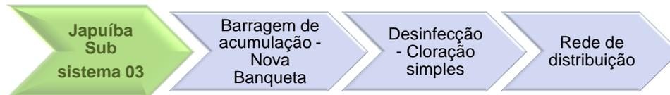
FIGURA 36 – FLUXOGRAMA DO SISTEMA DE ABASTECIMENTO DE ÁGUA JAPUÍBA – SUBSISTEMA 03
