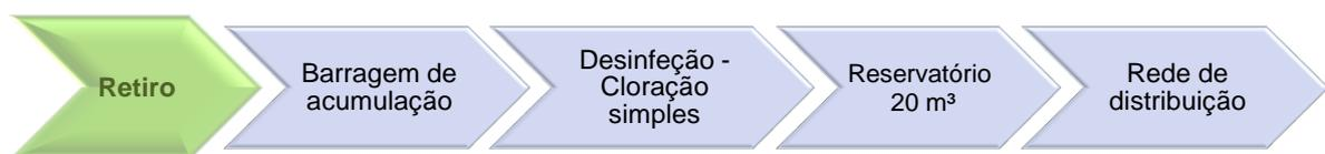
FIGURA 40 – FLUXOGRAMA DO SISTEMA DE ABASTECIMENTO DE ÁGUA RETIRO
