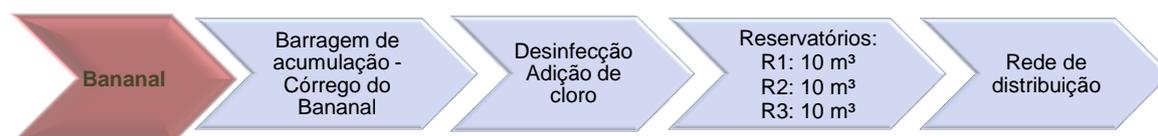
FIGURA 77 – FLUXOGRAMA DO SISTEMA DE ABASTECIMENTO DE ÁGUA BANANAL
