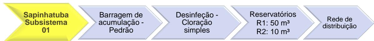
FIGURA 44 – FLUXOGRAMA DO SISTEMA DE ABASTECIMENTO DE ÁGUA SAPINHATUBA – SUBSISTEMA 01
