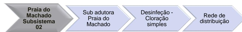
FIGURA 59 – FLUXOGRAMA DO SISTEMA DE ABASTECIMENTO DE ÁGUA PRAIA DO MACHADO – SUBSISTEMA 02
