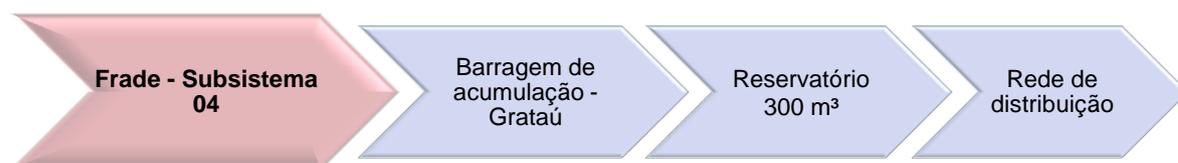
FIGURA 30 – FLUXOGRAMA DO SISTEMA DE ABASTECIMENTO DE ÁGUA FRADE – SUBSISTEMA 04
