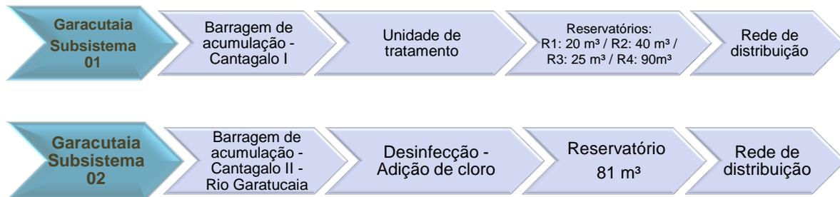
FIGURA 73 – FLUXOGRAMA DOS SISTEMAS DE ABASTECIMENTO DE ÁGUA DA REGIONAL GARATUCAIA (2021).
