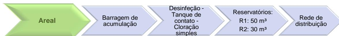
FIGURA 38 – FLUXOGRAMA DO SISTEMA DE ABASTECIMENTO DE ÁGUA AREAL
