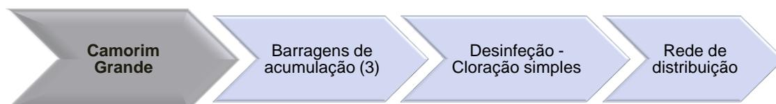
FIGURA 56 – FLUXOGRAMA DO SISTEMA DE ABASTECIMENTO DE ÁGUA CAMORIM GRANDE
