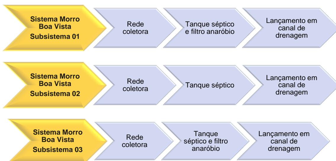
FIGURA 93 – FLUXOGRAMA DO SISTEMA DE ESGOTAMENTO SANITÁRIO MORRO DA BOA VISTA
