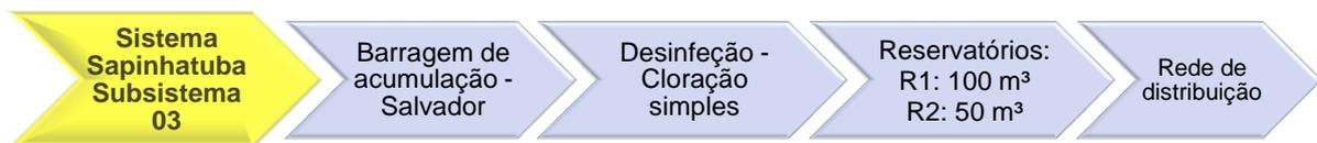
FIGURA 46 – FLUXOGRAMA DO SISTEMA DE ABASTECIMENTO DE ÁGUA SAPINHATUBA – SUBSISTEMA 03
