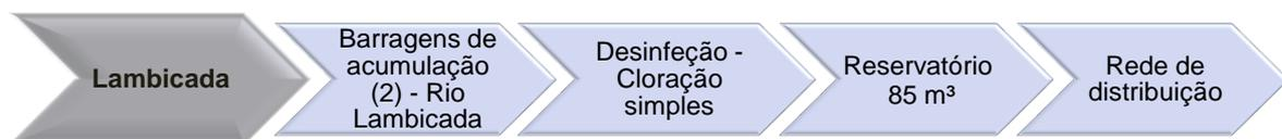
FIGURA 55 – FLUXOGRAMA DO SISTEMA DE ABASTECIMENTO DE ÁGUA LAMBICADA
