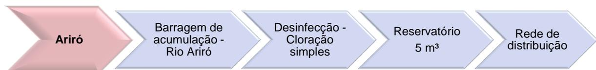
FIGURA 22 – FLUXOGRAMA DO SISTEMA DE ABASTECIMENTO DE ÁGUA ARIRÓ
