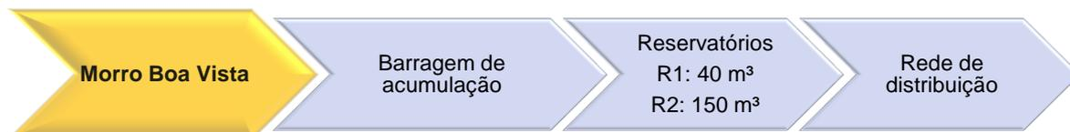
FIGURA 16 – FLUXOGRAMA DO SISTEMA DE ABASTECIMENTO DE ÁGUA MORRO BOA VISTA
