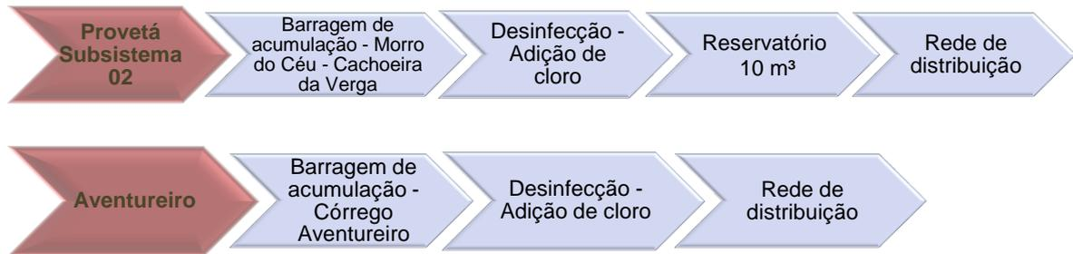
FIGURA 90 – FLUXOGRAMA DOS SISTEMAS DE ABASTECIMENTO DE ÁGUA DA REGIONAL ILHA (2021)
