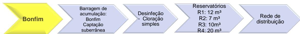
FIGURA 50 – FLUXOGRAMA DO SISTEMA DE ABASTECIMENTO DE ÁGUA BONFIM
