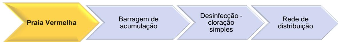
FIGURA 18 – FLUXOGRAMA DO SISTEMA DE ABASTECIMENTO DE ÁGUA PRAIA VERMELHA
