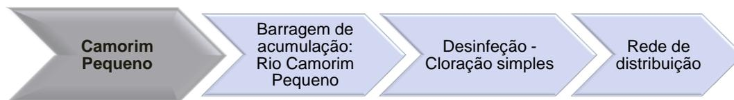
FIGURA 57 – FLUXOGRAMA DO SISTEMA DE ABASTECIMENTO DE ÁGUA CAMORIM PEQUENO
