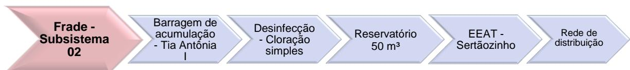
FIGURA 28 – FLUXOGRAMA DO SISTEMA DE ABASTECIMENTO DE ÁGUA FRADE – SUBSISTEMA 02
