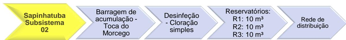
FIGURA 45 – FLUXOGRAMA DO SISTEMA DE ABASTECIMENTO DE ÁGUA SAPINHATUBA – SUBSISTEMA 02
