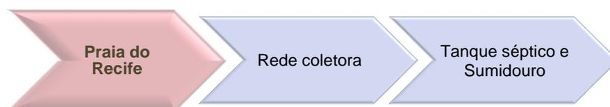
FIGURA 100 – FLUXOGRAMA DO SISTEMA DE ESGOTAMENTO SANITÁRIO PRAIA DO RECIFE
