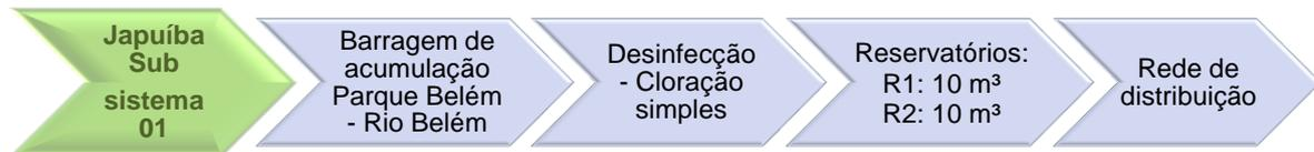
FIGURA 34 – FLUXOGRAMA DO SISTEMA DE ABASTECIMENTO DE ÁGUA JAPUÍBA – SUBSISTEMA 01
