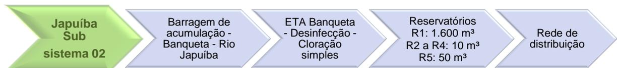
FIGURA 35 – FLUXOGRAMA DO SISTEMA DE ABASTECIMENTO DE ÁGUA SISTEMA JAPUÍBA – SUBSISTEMA 02
