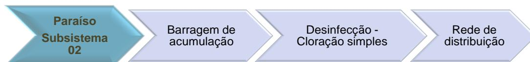
FIGURA 69 – FLUXOGRAMA DO SISTEMA DE ABASTECIMENTO DE ÁGUA PARÁÍSO – SUBSISTEMA 02
